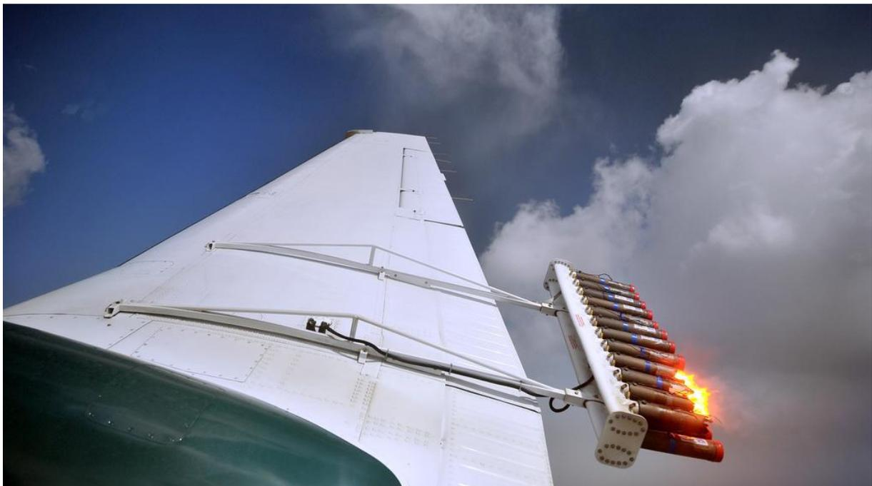
**Abbildung 16: Fackeln an der Unterseite von Tragflächen (Bardsley 2018)**
